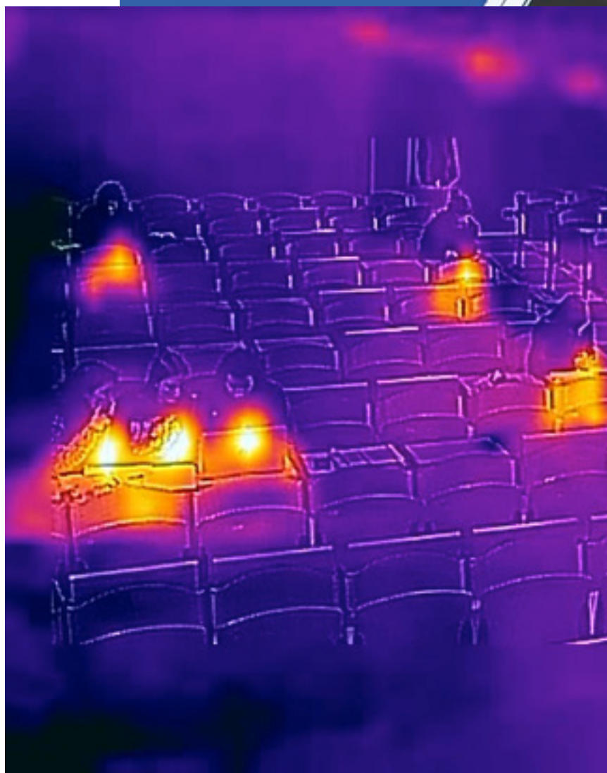
Figura 3: immagine dalla termocamera per la rilevazione di presenza nel rispetto della privacy
